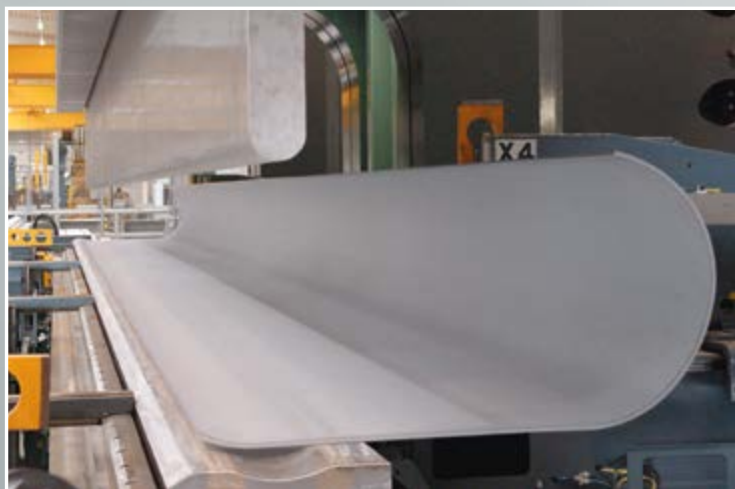
Пластины окантованы или сформированы, а затем сварены в трубы
