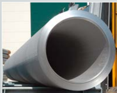
Пластины окантованы или сформированы, а затем сварены в трубы
